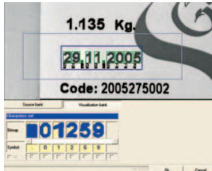
◀ Verpackung und Aufdruck mit OCR in einem Schritt geprüft. Die IVC-2D prüft nicht nur Geometrien, sondern erkennt und liest simultan Zahlen, Buchstaben und Barcodes, z.B. Verfallsdaten für Lebensmittel oder Chargennummern auf Medikamentenverpackungen. Damit wird das Kamerasystem zur Komplettlösung für die Prüfung von Verpackung und Aufdruck in einem Arbeitsgang.
