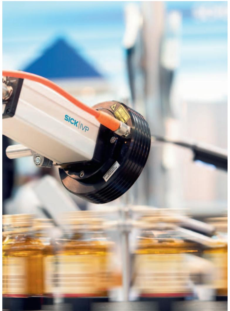
► Die flexible Kamera IVC-2D prüft mit Leichtigkeit viele Funktionen simultan – wie hier: Deckelposition, Füllstand und Etikett.
