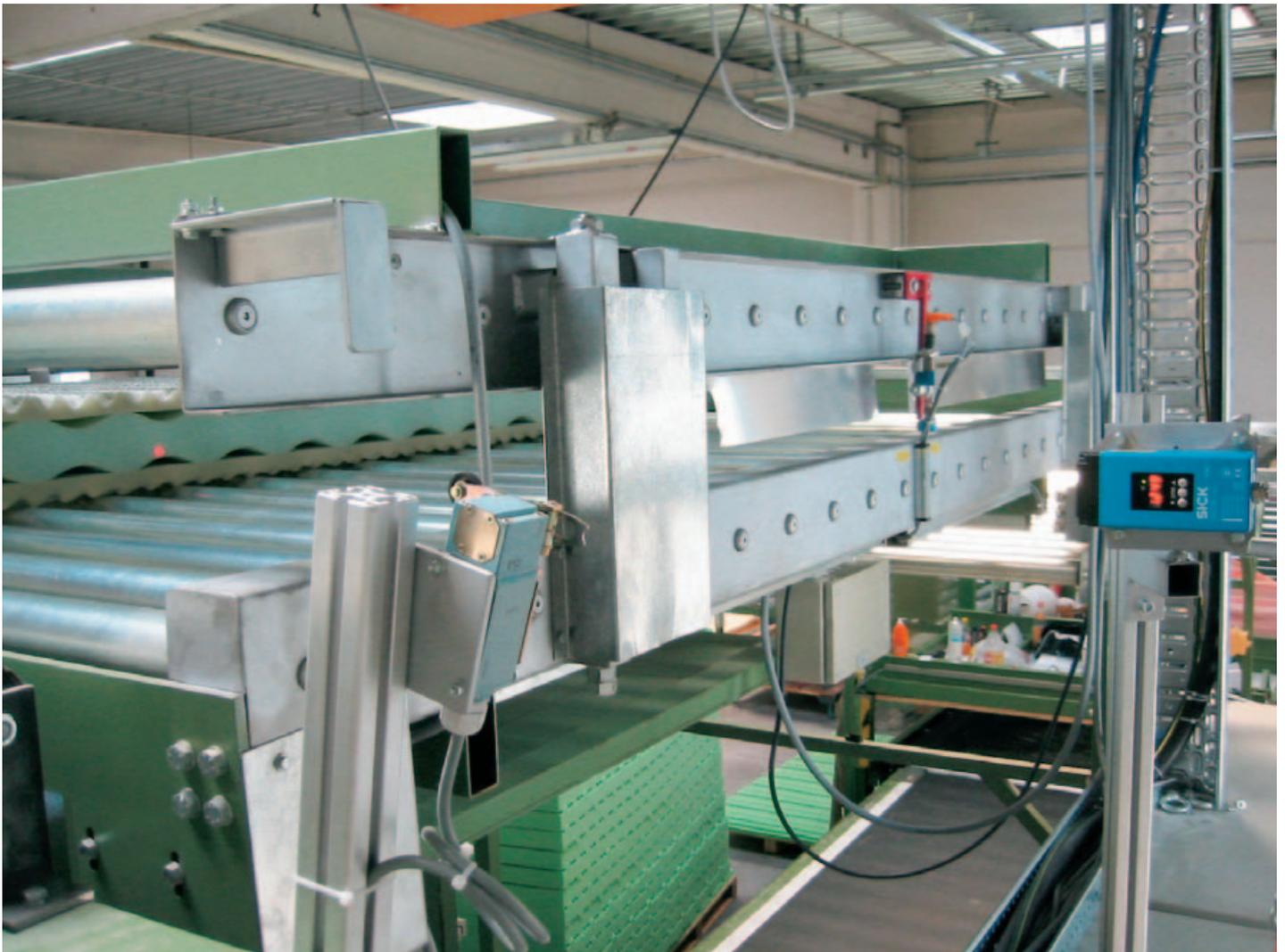
▲ Ein Laser-Sensor DMT 500 sorgt für die Zentrierung von Matratzen und bereitet sie somit für die Belemung und Aufbringung der Liegefläche vor.
