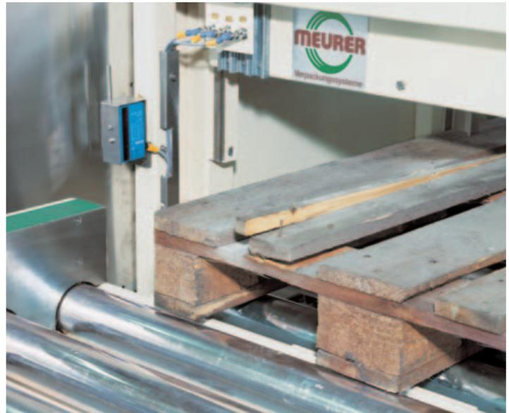
▲ Mit insgesamt acht parallelen Lichtstrahlen erkennt das Reflexions-Lichtgitter WLG 12 jede defekte Palette.
