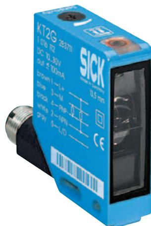
Neben einem 5-poligen M12-Normstecker verfügt der Kontrasttaster KT 2 über eine Schwalbenschwanz-Befestigungsmöglichkeit und zusätzliche Befestigungsbohrungen zur einfachen und flexiblen elektrischen und mechanischen Einbindung in vielfältige Umgebungen.
