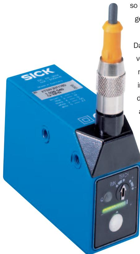
Durch den homogenen Lichtfleck und die automatische Schaltschwellenanpassung bei hochglänzendem Tastgut ist eine hohe Wiederholgenauigkeit gewährleistet. Eine Schaltfolge von 10.000/s garantiert einen wirtschaftlichen Produktionsablauf der Maschine. Ein breites Spektrum an Sensoren mit unterschiedlichen Tastweiten und individuelle Ausrichtungs- und Befestigungsmöglichkeiten decken zahlreiche Aufgabenstellungen ab.
