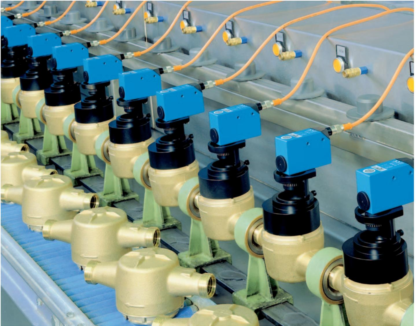
▲ Kontrasttaster KT bei der Wasserzählerproduktion.
