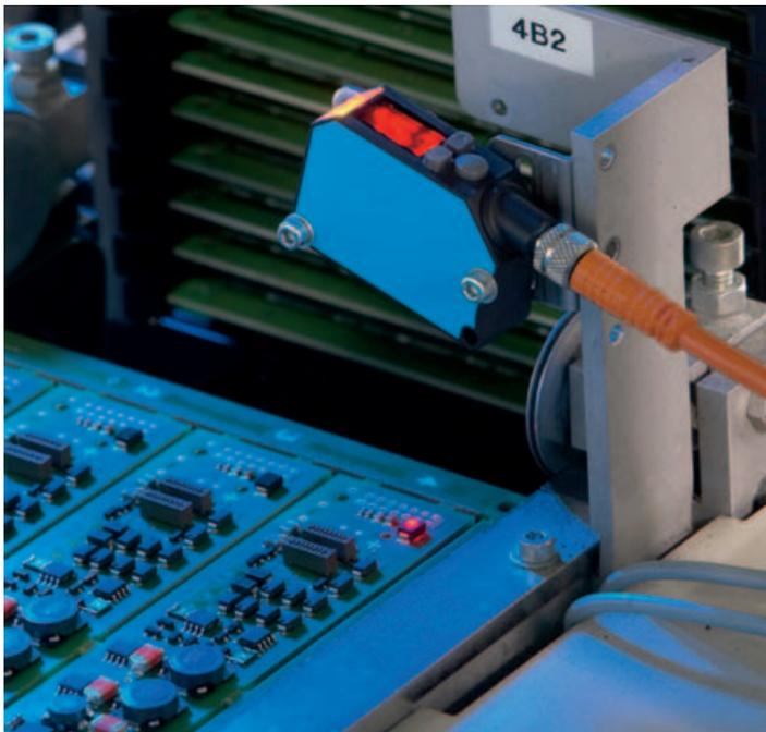
▲ WTB 190TL: Präzise Anwesenheitsprüfung von kleinen Bauteilen.
