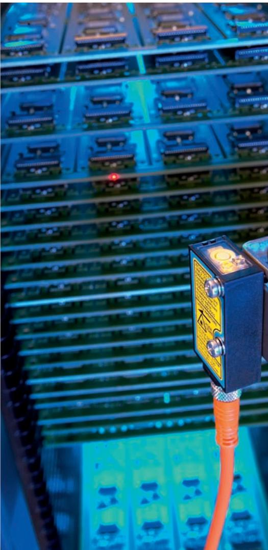
▲ Leiterplattenerkennung an der Stirnseite. Sicher umsetzbar
