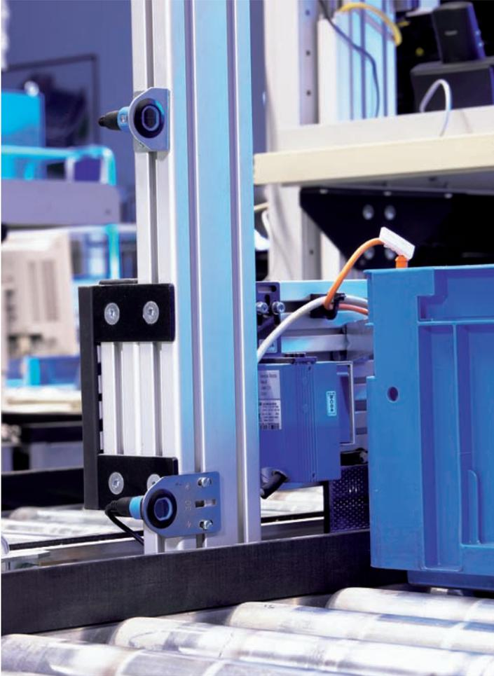
▼ Reflexions-Lichttaster MHT 15 zur Taktung von Werkstückträgern in einer Montagelinie.
