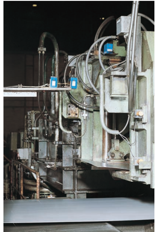
▲ Raueste Betriebsbedingungen herrschen in Stahlwerken – der Reflexions-Lichttaster WT45 ist bestens gerüstet, z. B. zur Blecherkennung bei Beginn der Coilaufwicklung.
