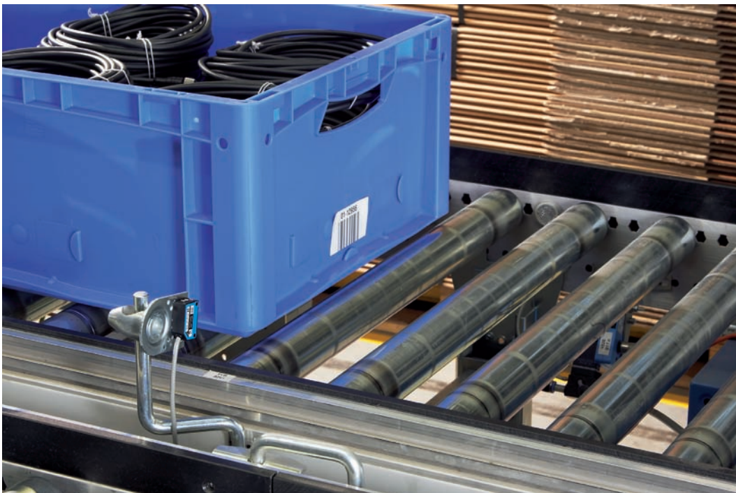
▶ Reflexions-Lichttaster WT100 mit Hintergrundunterdrückung erkennt zuverlässig Förderobjekte.
