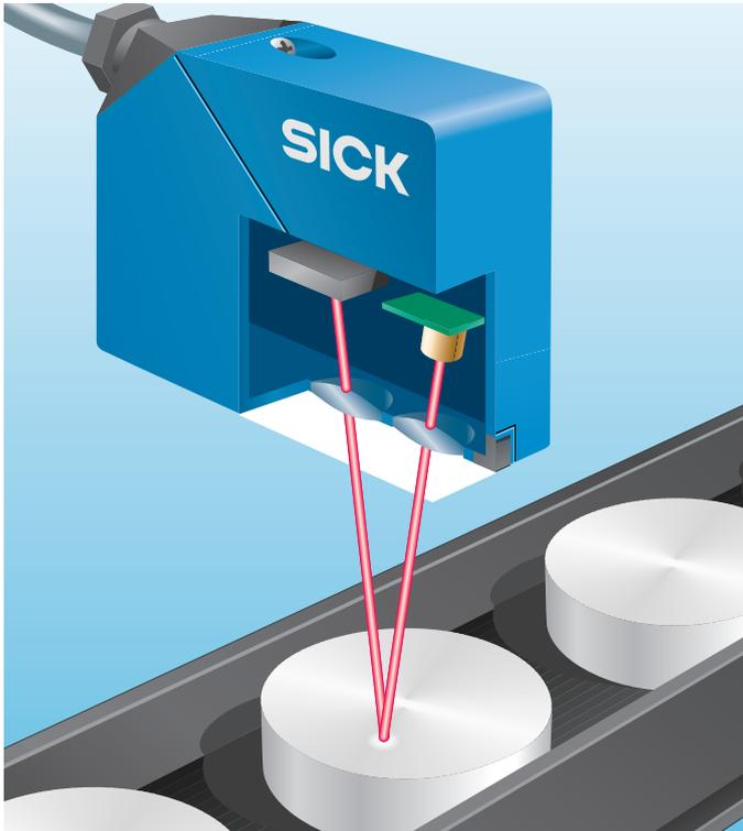
gen, werden erkannt. Was dahinter liegt, wird unterdrückt, da kein oder zu wenig Licht auf das Empfängerelement trifft. Bei der elektronischen Lösung werden PSD-Elemente (Position Sensitive Device) eingesetzt. Der ausgesandte Lichtstrahl wird vom Objekt remittiert und trifft auf das PSD-Empfängerelement. Abhängig vom Ort des auftretenden Lichtstrahls wird das Signal als Hintergrund erkannt und elektronisch unterdrückt.
