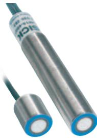
Wenn man mit Hilfe von Ultraschall zwei hintereinander liegende, dünne Bogen, z.B. Papier, Folien oder dünne Bleche, erkennen möchte, benötigt man getrennte Sende- und Empfangseinheiten. Die vom Sender permanent ausgestrahlten Schallwellen versetzen den ersten Bogen in Schwingungen, die er über die Luft auf den zweiten Bogen überträgt. Der zweite Bogen beginnt ebenfalls zu schwingen, und diese inzwischen stark abgeschwächten Signale registriert über die Luft schließlich die Empfangseinheit.
