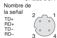
Disposición de los pins del conector macho, código D
