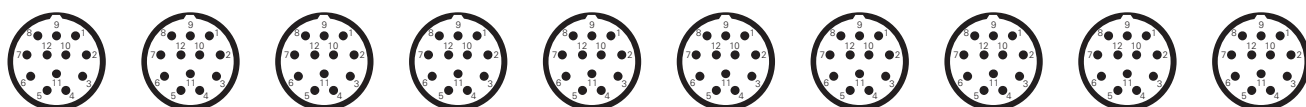
Connettore M23 a 12 poli Connettore M23 a 12 poli Connettore M23 a 12 poli Connettore M23 a 12 poli Connettore M23 a 12 poli Connettore M23 a 12 poli Connettore M23 a 12 poli Connettore M23 a 12 poli Connettore M23 a 12 poli Connettore M23 a 12 poli
