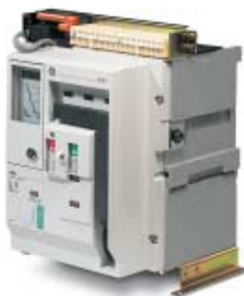
L'interruttore M-Pact in esecuzione fissa può essere installato in qualunque quadro o armadio elettrico con l'uso di quattro viti M8. Per gli armadi della serie Modula 4000 IP55 è stata realizzata un'apposita unità funzionale.
