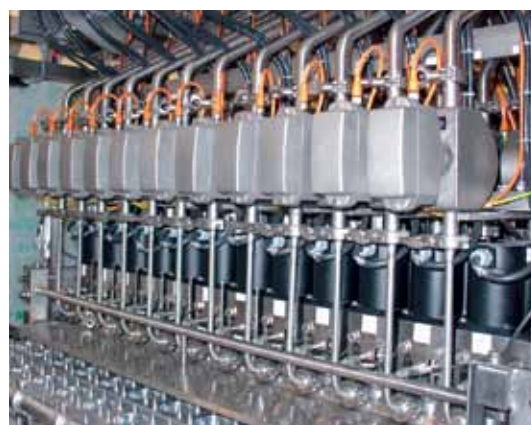
Misuratore di portata Dosimass in funzione su una riempitrice in linea con 12 postazioni di riempimento
