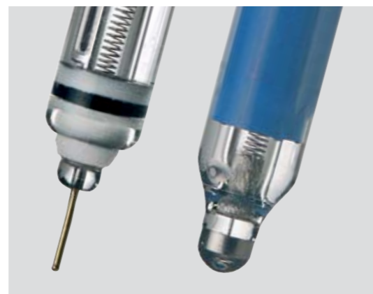
Elemento in oro o anello di platino come elettrodo di misura
