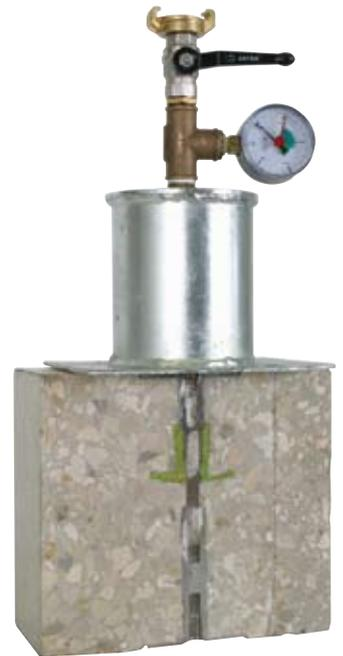
Ricostruzione della prova (sezionamento) con collegamento per la prova con acqua in pressione
