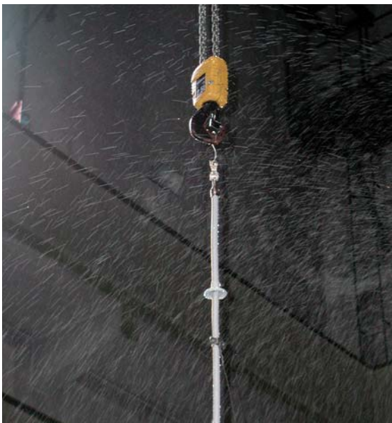
Figura 5.7.1.3 Prova in tensione sotto pioggia
