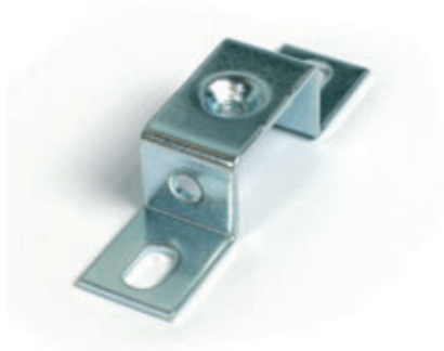
Interasse di fissaggio con vite 6 MA da 60 a 70 mm
